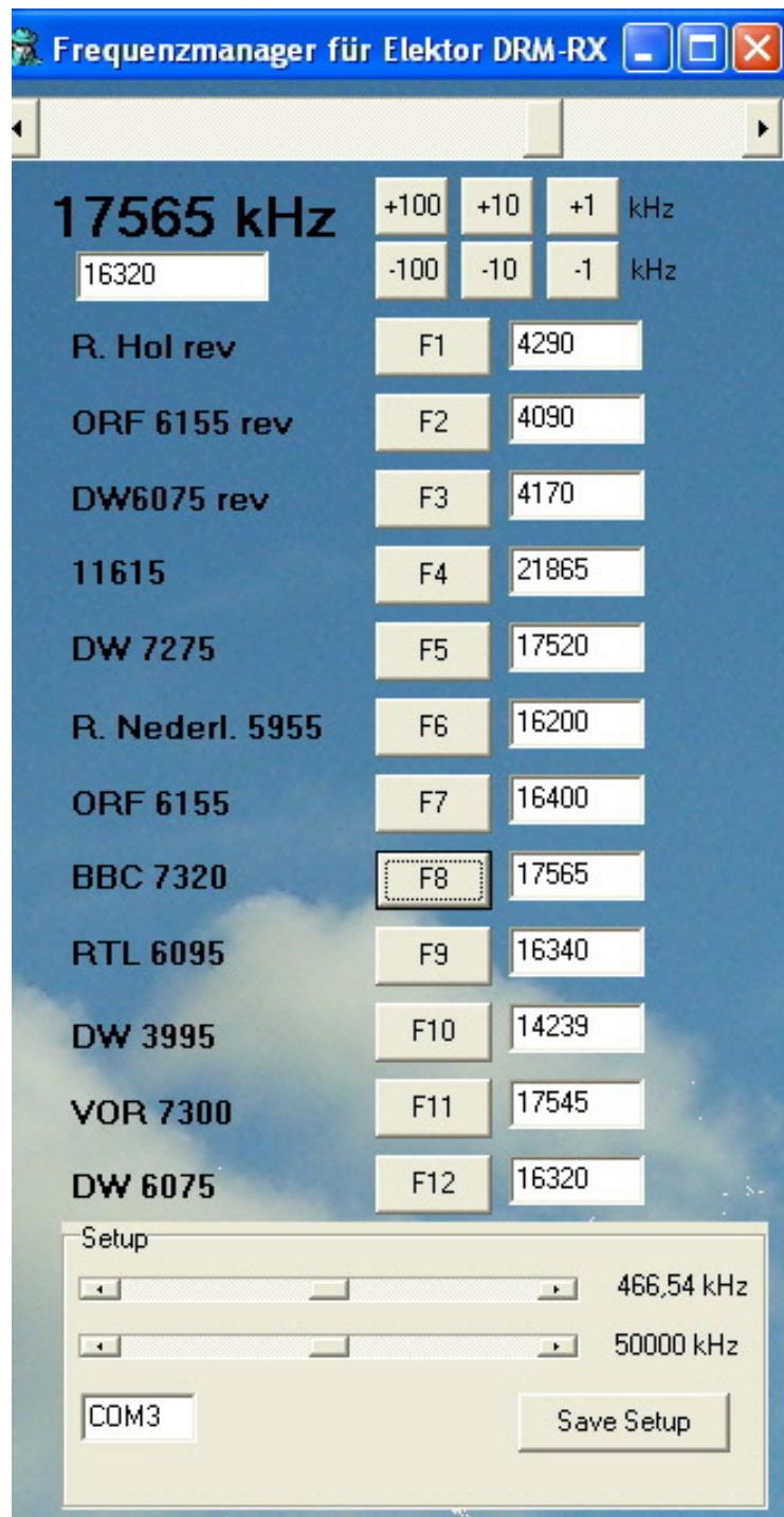
Ganz bewußt habe ich bei einigen Sendern die obere (normale) und untere VFO-Frequenz gespeichert. Jetzt kann man im direkten Vergleich sehen, ob eine Störfrequenz stört oder ob das Problem im Signal selbst liegt. Im Gegensatz zur 455 kHz-Version, ist die Anzahl von Spiegelfrequenzstörungen klein geworden.
