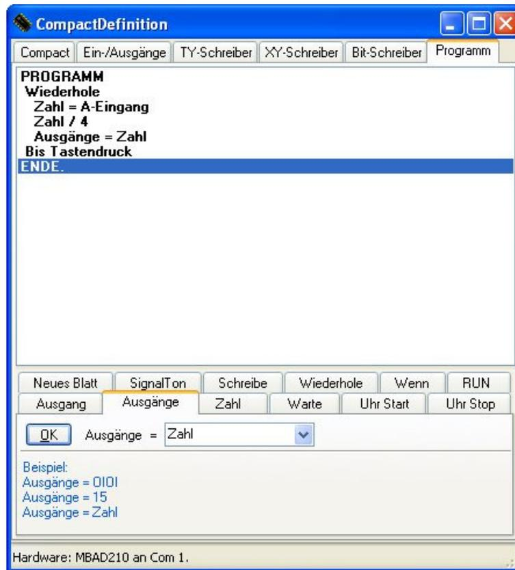
Die Programmierumgebung erlaubt die Automatisierung einfacher Mess- und Steuerungsaufgaben. Das Beispiel zeigt eine Umsetzung der Eingangsspannung in ein PWM-Signal. Die Eingänge liefern einen Zahlenbereich bis 1023, während der PWM-Ausgang einen Ausgangsbereich bis 255 besitzt. Der Messwert muss daher vor der Ausgabe durch vier geteilt werden. Die PWM-Ausgabe verwendet den Befehl „Ausgänge“, der bei anderen Interfaces acht digitale Ausgangsleitungen steuert.
