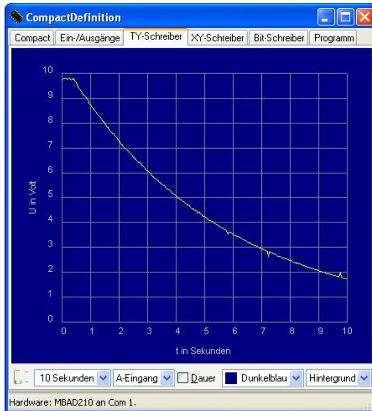
Im Fenster TY-Schreiber lassen sich Spannungsverläufe an einem Kanal oder an beiden Kanälen plotten. Entsprechend trägt der XY-Schreiber beide Kanäle gegeneinander auf und dient z.B. für die Erfassung von Kennlinien usw.
